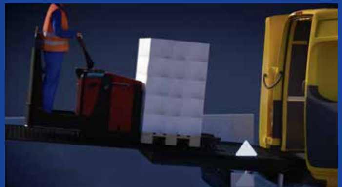
Compensation hydraulique de la pression du poids jusqu'à 150 kg
