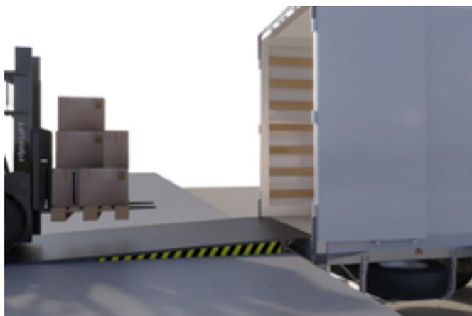
Positionnement correct du niveleur dans le véhicule.
